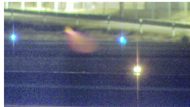
図 13 350m 離れた位置に配置した標準反射体（小）の検出例
