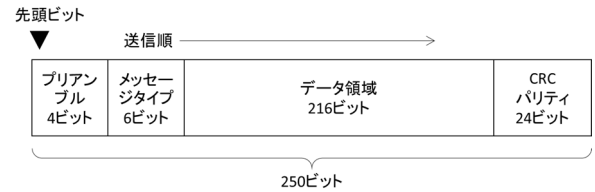
図1 L5 SBASのメッセージの構造 Figure 1 Structure of L5 SBAS Message.
