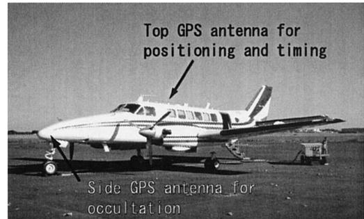
図 2 実験用航空機 (Beechcraft B99 Airliner)
