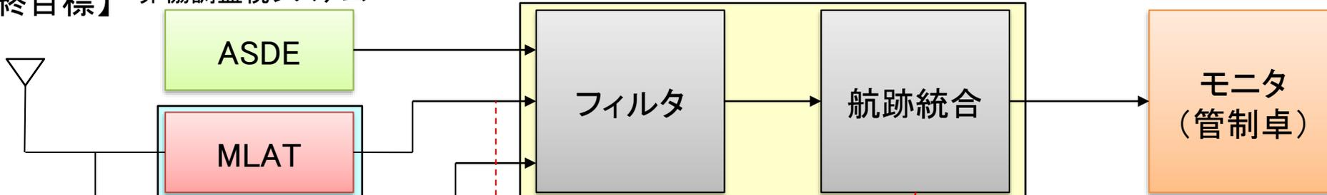
運用機材が正しく動作しているか、おかしな挙動の航空機がないかは第三者として立てた評価装置で行う
