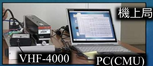
実験用航空機—地上局 のACARS通信システムに導入し
