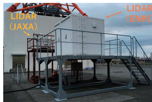
図 3. 電子航法研究所 (ENRI) と宇宙航空研究開発機構 (JAXA) の LIDAR 装置
