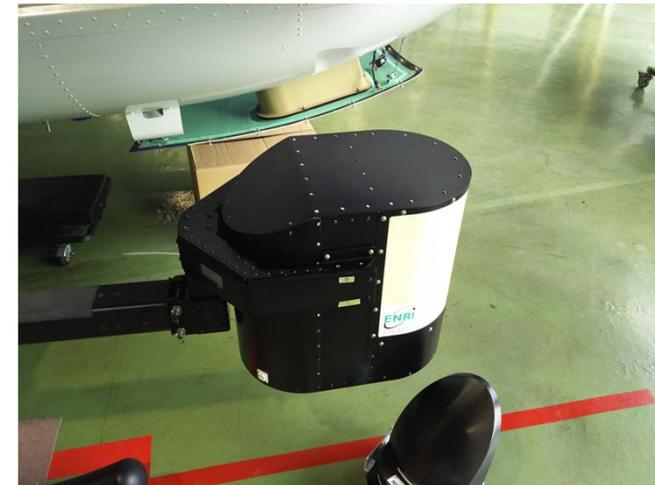
開発した前方監視用ミリ波レーダを用いたヘリコプタ搭載試験を
