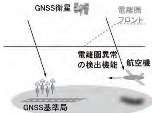
図4. CAT-IIIにおける航空機上での検出を含めた電離圏異常への対策
