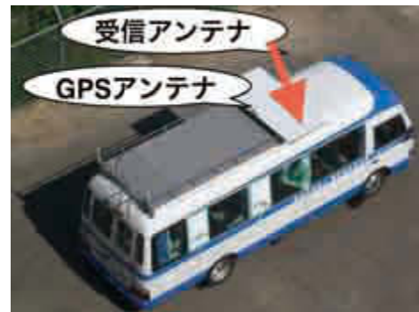
図 5 受信および GPS アンテナ設置状況
