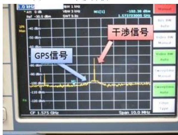
図3 連続波を混入した合成信号の例
