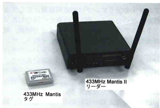
図2 ビーコン方式アクティブタグシステム (RF CODE 社製)
