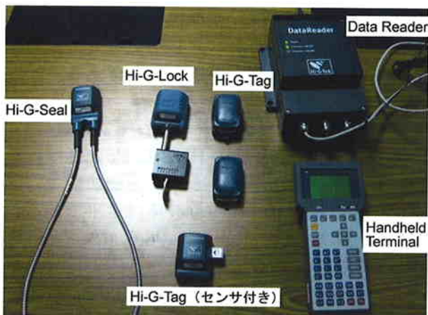
図1 マスター・スレーブ方式アクティブタグシステム (Hi-G-Tek 社製)
