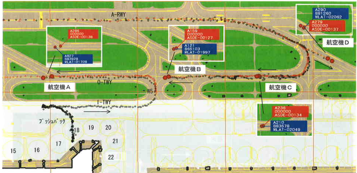
図17 エアライン機による航跡記録例 (A滑走路側)
