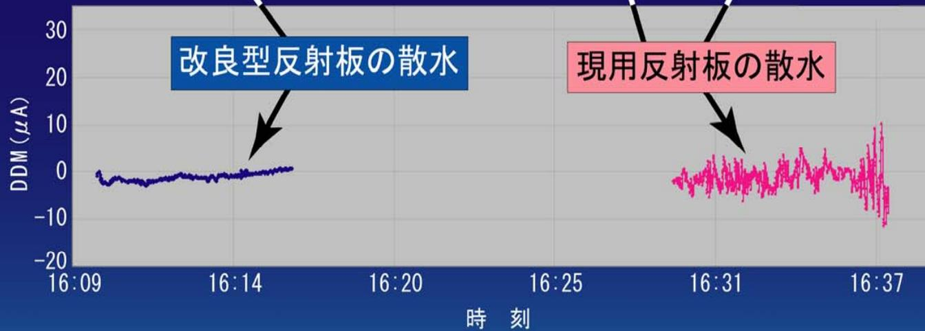
図11 GP 反射板に散水したときのDDM測定
