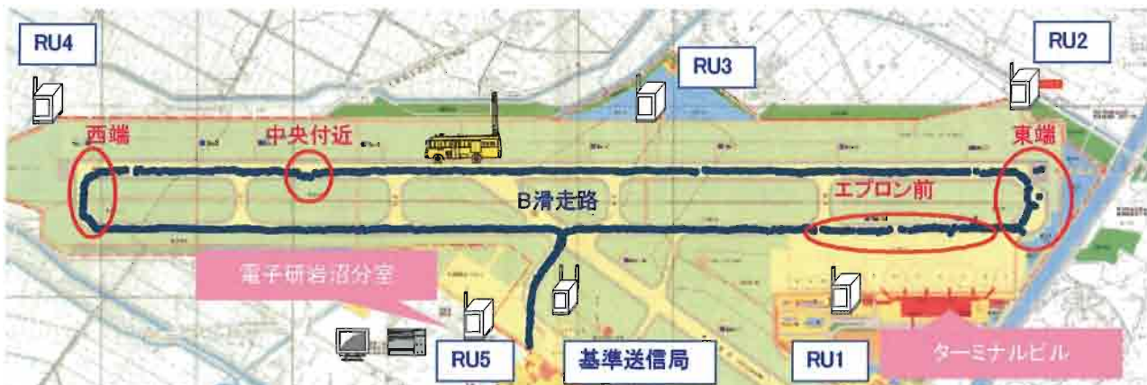
図4 評価システムの配置と追尾処理後の航跡(2003年12月評価実験)
