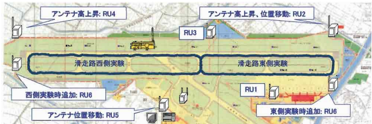
図10 評価システムの配置と追尾処理後の航跡(2004年9月評価実験)
