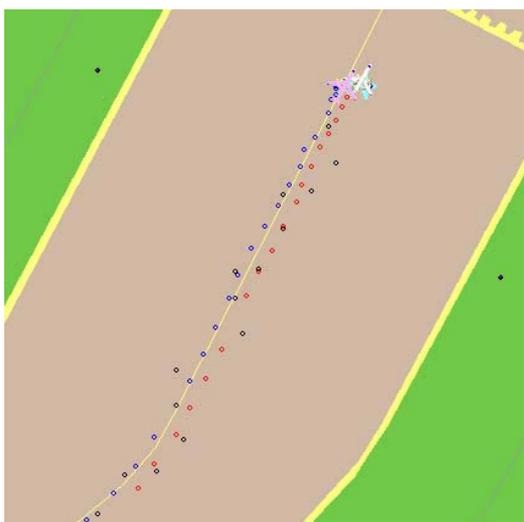
図7 複数センサによる航空機航跡記録例
