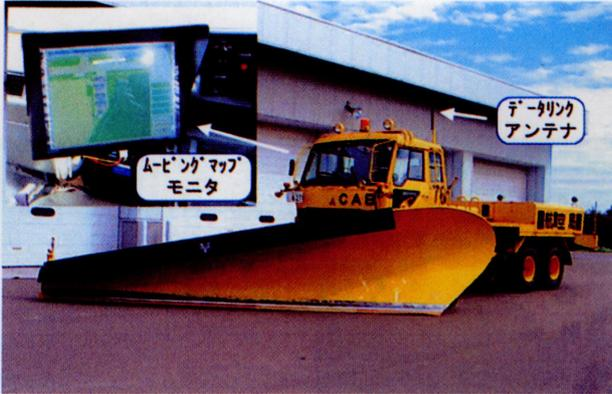
図6 スノープラウ除雪車への搭載例
