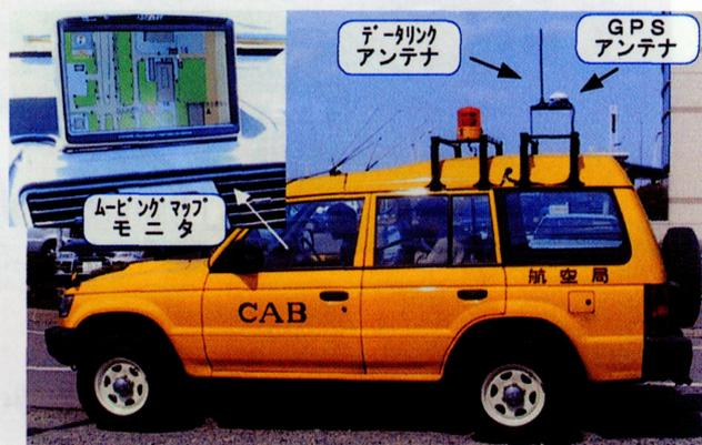
図5 業務用車両への搭載例
