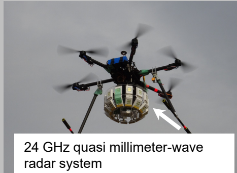
図4. ドローンに搭載した全周障害物探知システム
