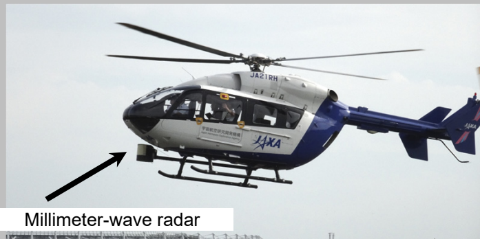
図1. 前方障害物探知システムを搭載した実験用ヘリコプタ
