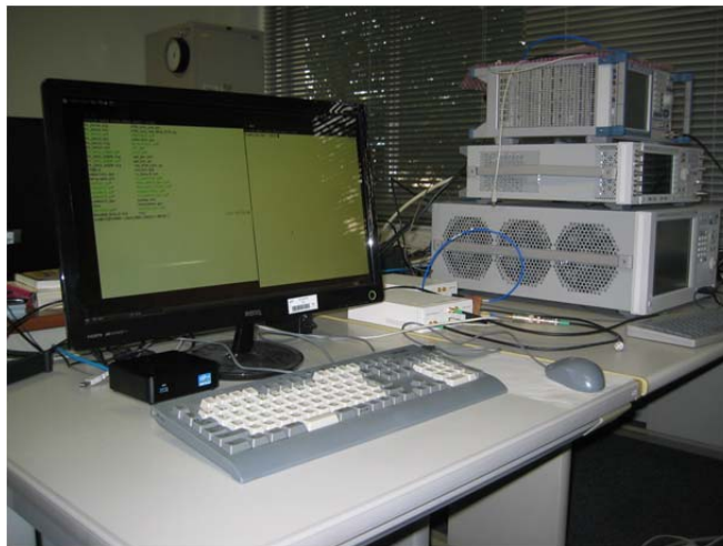
図 1.1.21 LDACS 物理層実験システム (LPES)
