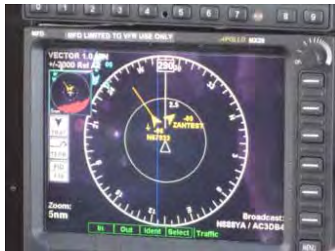
図 3.2.10 飛行実験中の UAT 表示画面。自機(円中心の三角)および周辺機(黄色三角)が表示されている。
