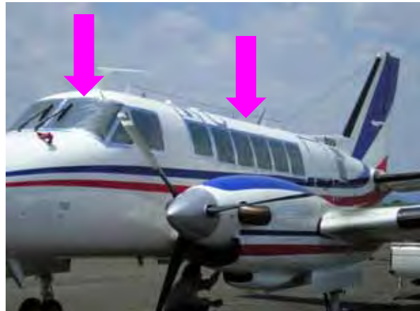
図 3.2.29 B99 に貼付した電磁遮蔽材
