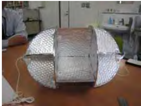
図 3.2.35 評価した小型船舶用レーダ反射器
