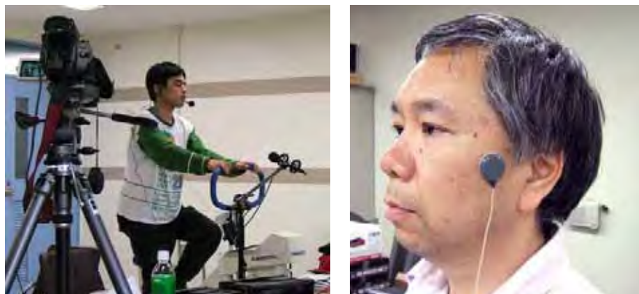
図 42 実験状況（左：エルゴメータによる負荷実験、右：自吸型骨伝導マイク）
