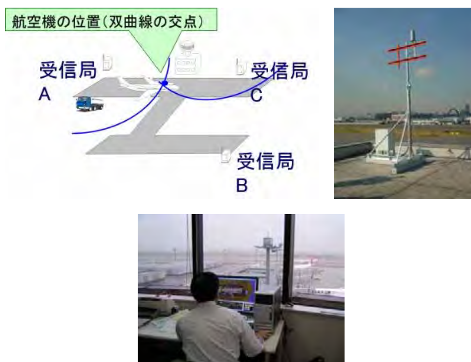
図 33 マルチラレーション監視システム（羽田空港）
