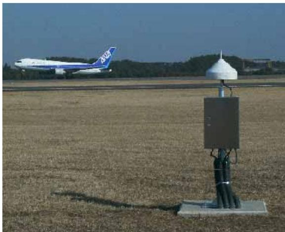
【 従来のチョークリング型基準局アンテナ 】
