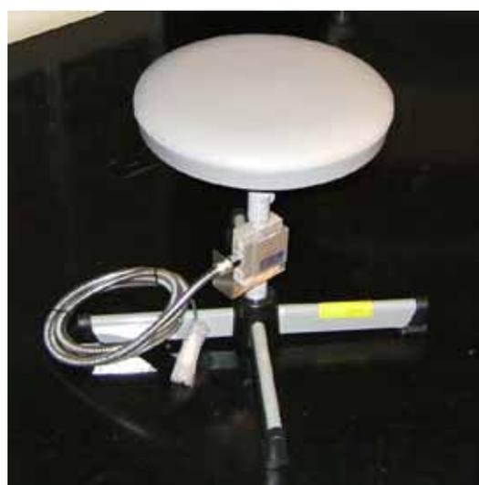
【 縦方向加速度計測用腰掛け 】
