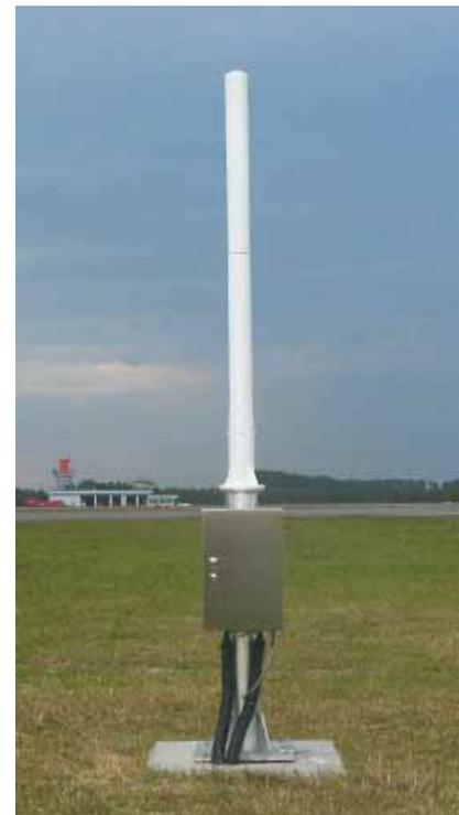
【 評価中の 21 段 84 素子の新型アレイ型基準局アンテナ 】
