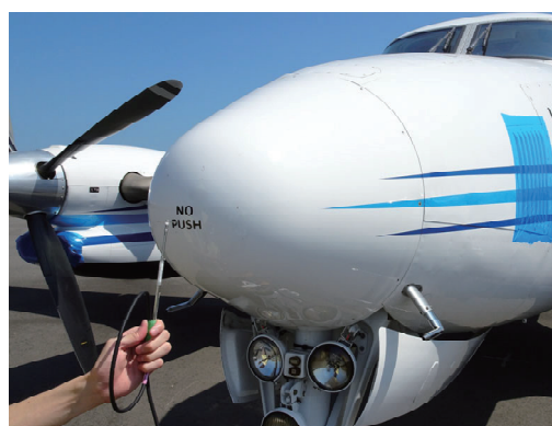
図2. ビーチクラフト B300 型機干渉経路損失測定状況
