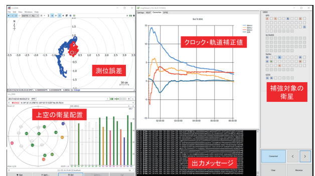
図3 次世代SBAS実証実験中の画面表示例 （左上）補強なし（青）に対して補強あり（赤）では測位誤差を低減，（中央上）欧州Galileoの8番衛星の補正情報が時間の経過とともに収束
