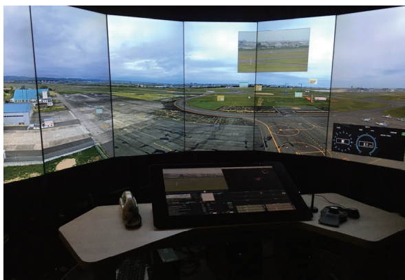
図3 システムの表示系と統合型のHMI
