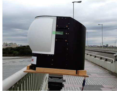
図1. ミリ波レーダ地上試験状況 (レドーム形状および材料変更)
