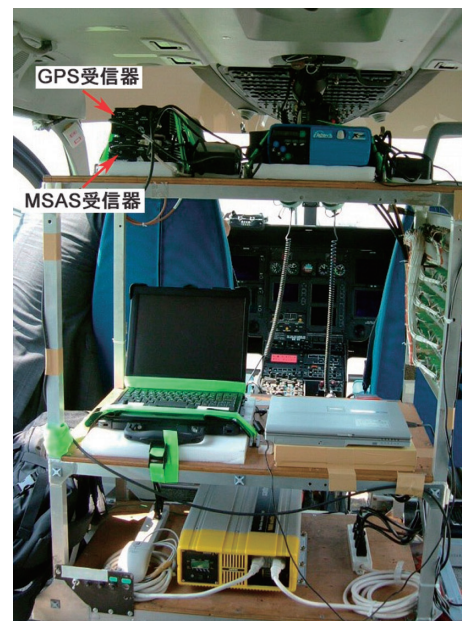
図1 ヘリコプターに搭載したGPS/MSAS受信装置
