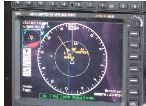
図3 飛行実験中の操縦席MFD表示の例 (中央の白三角が自機で、黄色の楔形が周辺のADS-B機、白い円の左上に見える水色の花びら形がTIS-B機)
