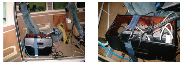
図2 測定記録装置の航空機内実装状況
