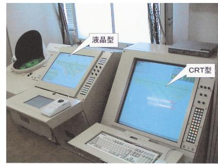
図3 液晶型高機能表示装置
