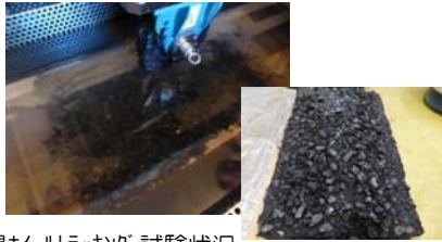
水浸ホイールラッキング試験状況 試験後の供試体
