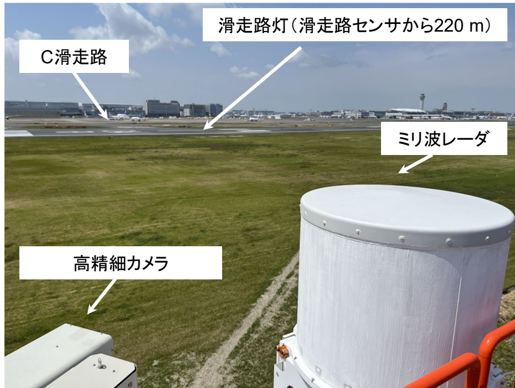
滑走路センサ設置位置からの 滑走路の見通し状況
