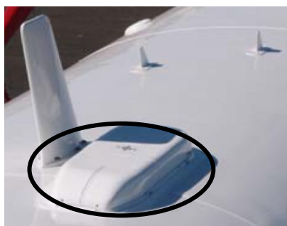
インマルサット航空機搭載アンテナ
