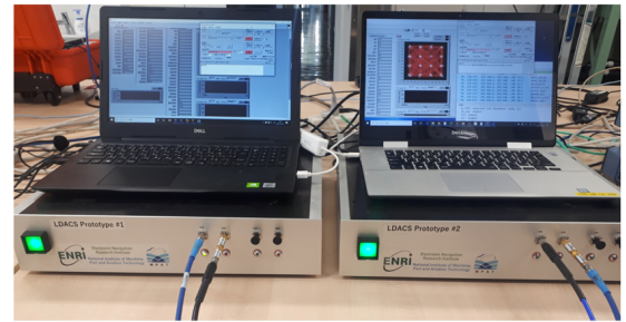
図 9. LDACS プロトタイプと試験構成
