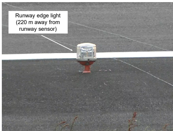
図8 カメラ画像例（距離220 m滑走路灯）
