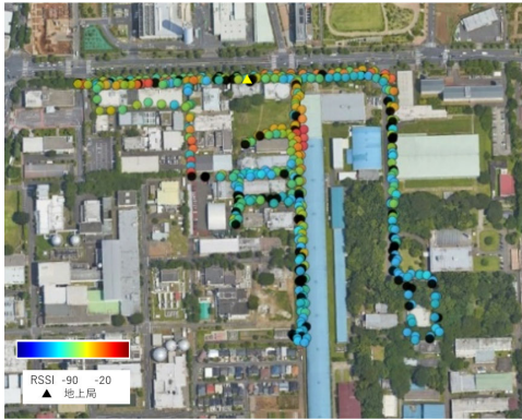
図 8. 構内地上走行試験結果
