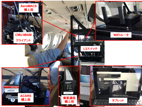
図 14. 実験用航空機よつばの搭載状況
