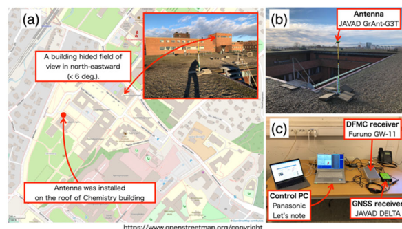
図 3. (a) オスロ大学の俯瞰図とアンテナ設置位置。(b) アンテナ外観。(c) 受信機とパソコン。
