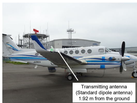
図4 WAIC 機器を想定した航空機地上放射特性評価試験状況概観
