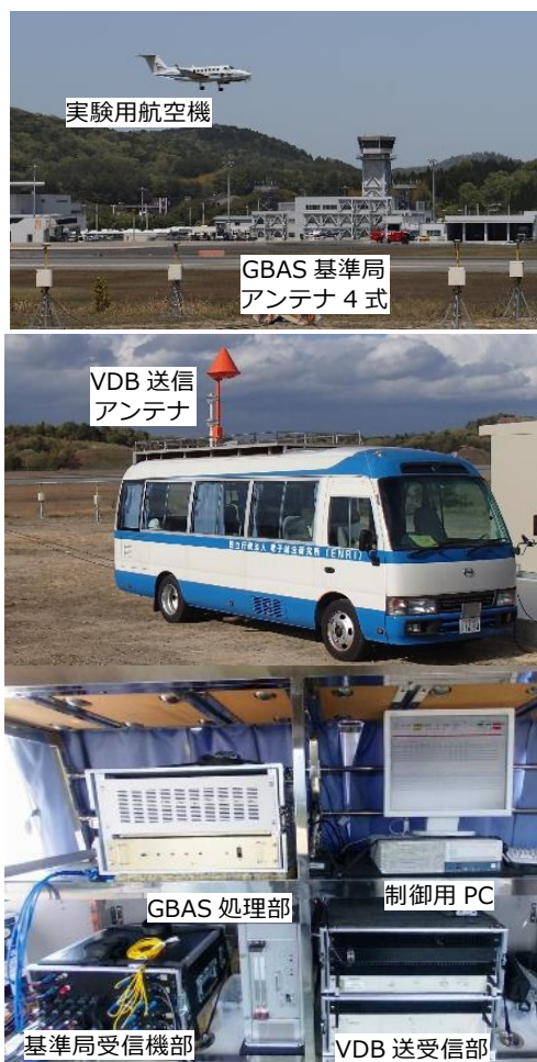
図 4：可搬型 GBAS の外観と広島空港における飛行実証の様子
