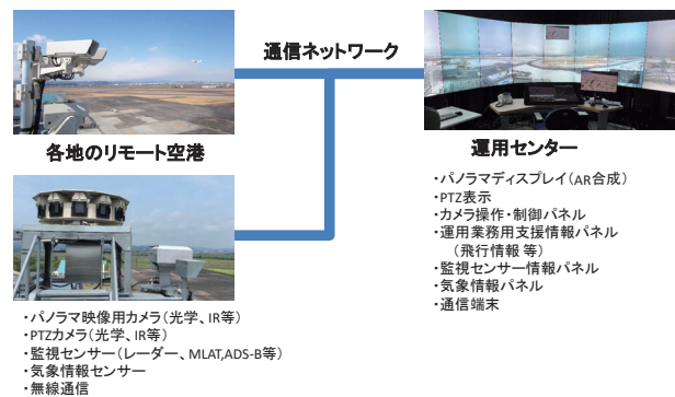
図1 リモートタワーシステムの構成概要
