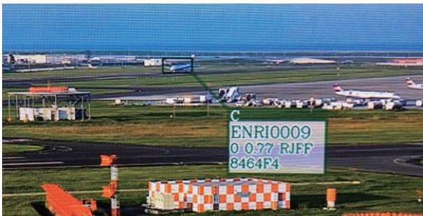
図5 動体検知のボックスと監視センサ（MLAT）情報に基づくラベル表示例
