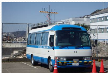
実験車両 (上部にアレアンテナ)
