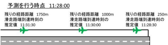
図4 誘導路を走行中の出発便における滑走路端到達時刻の推定
