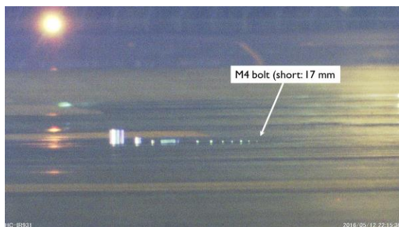
図8 開発品カメラの異物サンプルの撮影例
