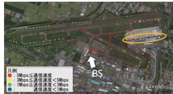
図4 平成 26 年度の通信速度実験結果 (弊所岩沼分室付近に BS を配置した場合)
