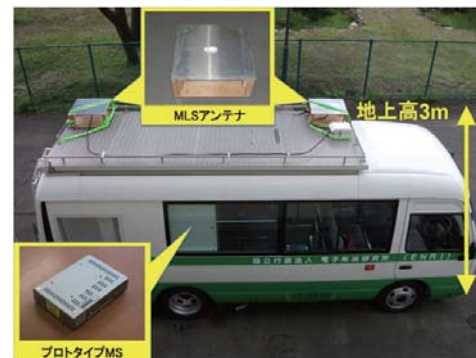
図2 移動局構成の外観
