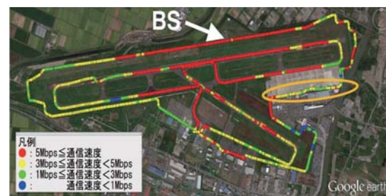
図5 平成 27 年度の通信速度実験結果 (消防庁舎付近に BS を配置した場合)
