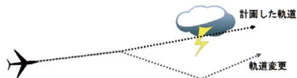
図6 TBO における飛行中の軌道修正
