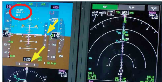
図 13: 慣熟飛行期間における B787 実機の最終進入時の PFD 及び ND (Navigation Display)
