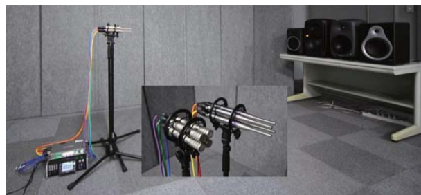
図 5 マイクロフォンの差異の評価実験概観
