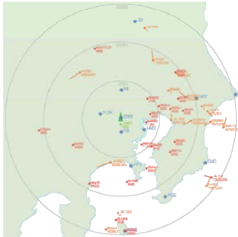
図 5：機上で受信した TIS-B および ADS-B 情報の簡易プロット。中心が自分の位置（GPS によって取得）であり、赤点が TIS-B 情報、オレンジ点が ADS-B 情報を示している。
