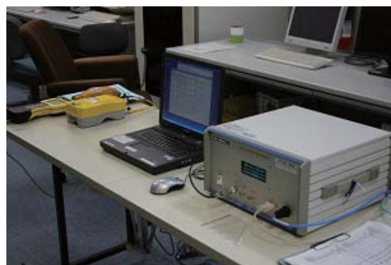
図 4 L1-SAIF プロトタイプ受信機
