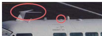
図 2: VHF アンテナ (左) と GPS アンテナ (右)
