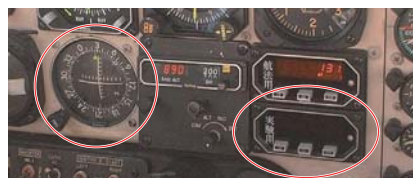
図 3: 実験用計器, CDI (左) と DME 表示器 (右)
