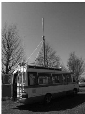
図 4 TIS-B サーバの設置状況。河川敷駐車場にて設置した実験用車両と TIS-B 送信アンテナ（右写真）。車内に設置した送信機およびそれらの制御装置（左写真）
