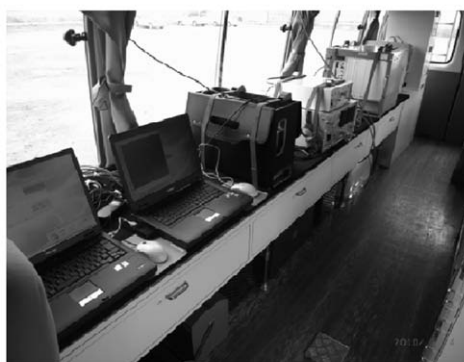
図 4 TIS-B サーバの設置状況。河川敷駐車場にて設置した実験用車両と TIS-B 送信アンテナ（右写真）。車内に設置した送信機およびそれらの制御装置（左写真）
