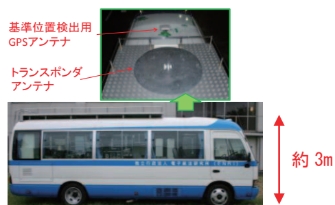
図4 実験用車両およびアンテナ外観
