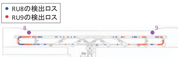
図6 B滑走路における信号検出ロス発生箇所
