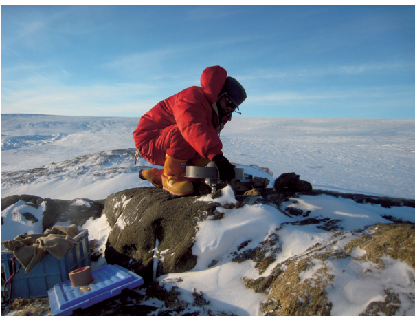
写真6 野外でのGPS観測作業
