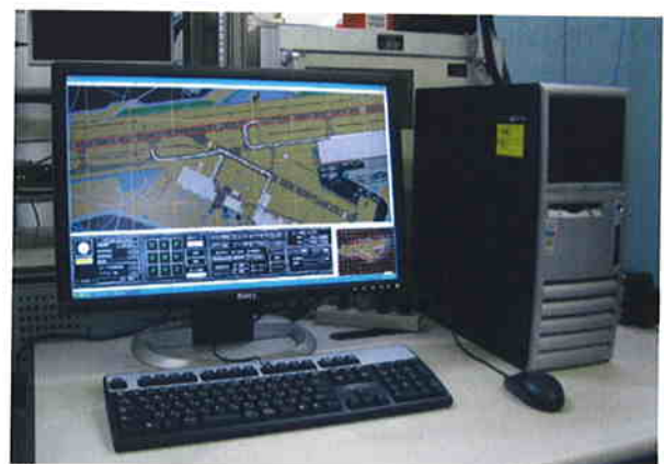
図13 管制用監視モニタ表示装置外観
