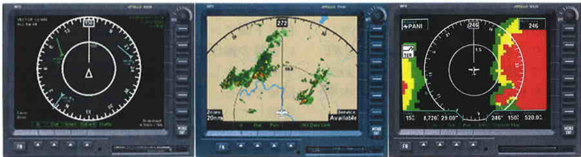
図1 「キャプストーン機上装置」(MFD)の例 (左から周辺交通状況、気象、地形の切替え表示例)
