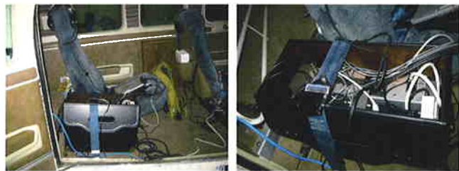
図3 測定記録装置の航空機内実装状況
