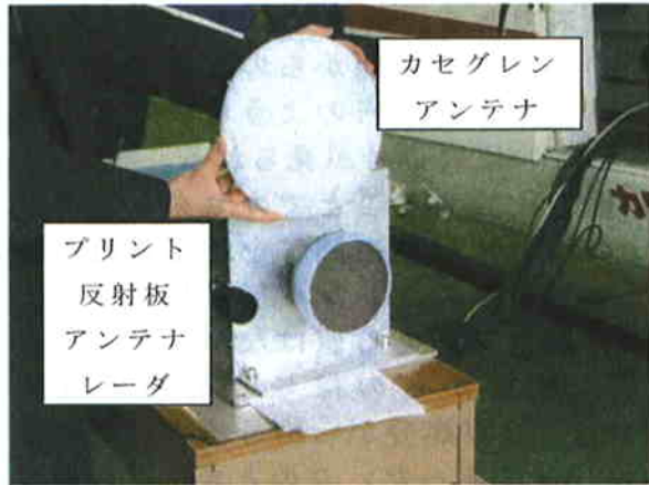
図4 搭載型プリント反射板アンテナ レーダとカセグレンアンテナ
