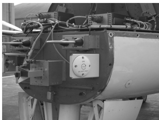
図 7: 実験用航空機ノーズ内に取り付けた GPS アンテナ
