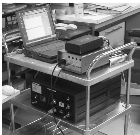
図 3: SQM 受信装置の外観 (ラック下段) 電気通信大学菅平宇宙電波観測所における実験時に撮影
