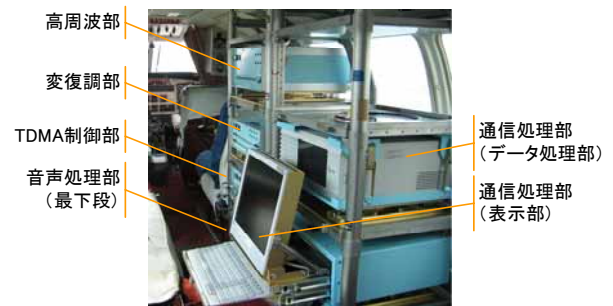
図 12 VDL3 機上局搭載状況
